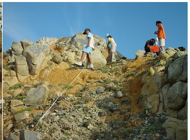
照片 11：石英安山岩質岩脈容易風化，大部份 常形成較低窪地(皮尺部份)。
