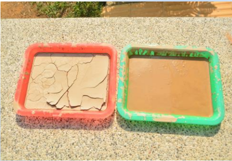
花嶼的粘土溶於水晒乾後，容易形成剝裂狀。
