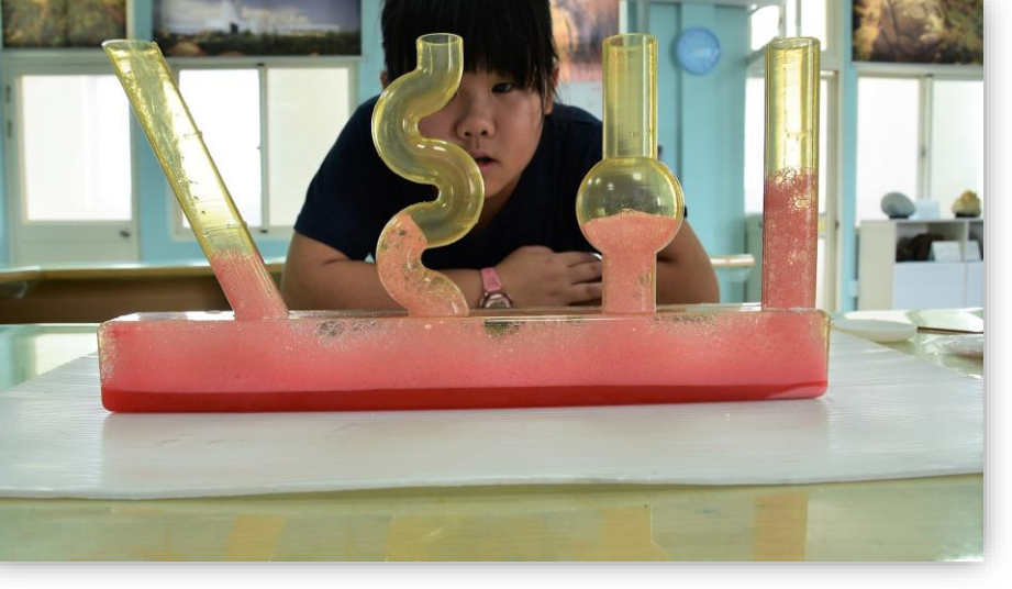
泡泡順著不同的管形向上流動，就像陸地上彎曲或直行的岩脈情形。
